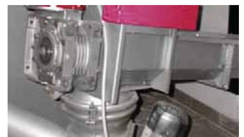
Șnec împingător cu tobogan protejat anti-incendiu
