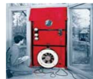
Exemplu de testare a punctelor de conflict din anvelopanta unei clădiri prin metoda Blower Door Test.
